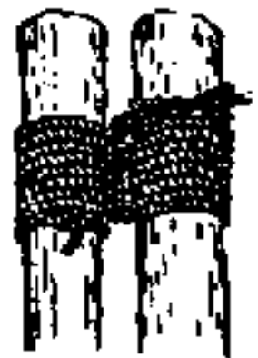
Amarre Redondo. Hágase el ballestrinque alrededor de uno de los postes. Dénse unas vueltas alrededor de los dos postes. Apriétese. Terminese con el ballestrinque.
